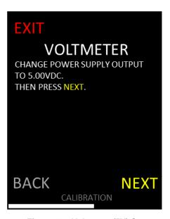
Figure 18. Voltmeter (5V) Setup
